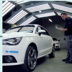
Lichttunnel zur Qualitätskontrolle Quality control light tunnel
