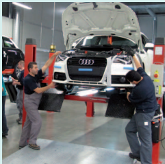
Montage Seitenschweller und Frontspoiler Side skirts and a front spoiler being mounted
