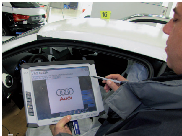
Ein Formel D-Mitarbeiter überprüft nach der Montage des Sportlenkrads den Fehlerspeicher des Audi A1 A Formel D employee checks the sport steering wheel memory of an Audi A1 after the installation
