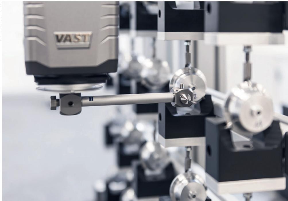
Das Koordinatenmessgerät vermisst auch die komplexesten Einzelteile präzise und zuverlässig.
